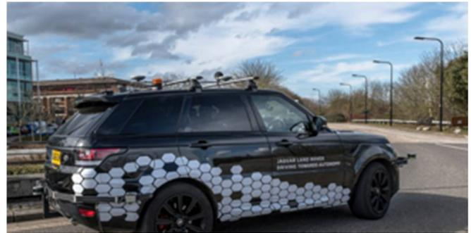
Im Rahmen der Straßentests erprobt Jaguar Land Rover zahlreiche intelligente und vernetzte Systeme, darunter den Bremsalarm EEBL (Emergency Electronic Brake Light warning), den Rettungswagenalarm EVW (Emergency Vehicle Warning) und Fahrzeug-Informationssysteme (IVS – In-Vehicle Signage) für Baustellenwarnung (RWW – Roadworks Warning) und Verkehrslagewarnung (TCW – Traffic Condition Warning).
