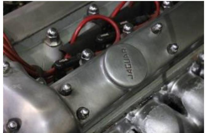
Der XK 120 wurde vom XK-Motor befeuert. Der 3,4-Liter Reihen-Sechsender brachte 160 ehrliche PS auf die Kurbelwelle, die über 4 Gänge und 16-Zoll-Räder auf die Straße gebracht wurden. Der XK-Motor war übrigens der erste Jaguar-Motor mit zwei oberliegenden Nockenwellen (DOHC) – eine Konstruktion, die bis dahin nur in kleinsten Stückzahlen und meist per Hand produziert wurden. Dieses Meisterstück aus Leistungsfähigkeit und Zuverlässigkeit wurde noch bis 1992 in diverse Modelle verbaut.
