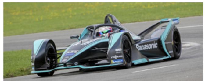
Damit können die Fahrer innerhalb einer klar definierten Zone der Strecke für kurze Zeit die Leistung von 200 auf 225 kW erhöhen. Um den Zuschauern zu signalisieren, welcher Pilot gerade die Zusatz-Kilowatt abrufen, leuchten in diesem Modus die LED am neu eingeführten FIA-Schutzsystem HALO in einer abweichenden Farbe auf.
