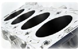
Bei aller Technik lebt ein Supersportwagen aber auch von der Emotion. Die soll durch Sound und Leistung im Überfluss geweckt werden. Für beides sorgt der 1,6-Liter-Vierzylindermotor (im Bild das Motorgehäuse aus Aluminium), der mindestens 500 PS leisten soll und dabei 10.000 Umdrehungen pro Minute orgeln.
