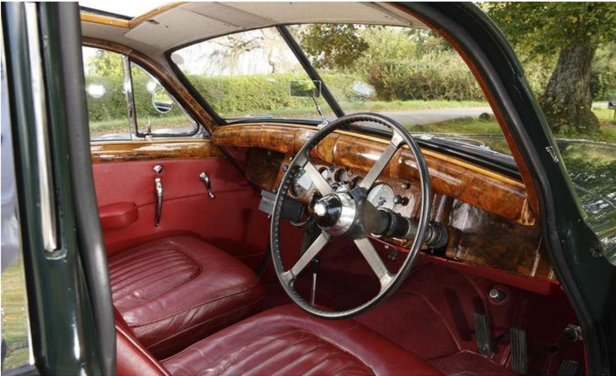
Ein kurzer Mittelschalthebel und der große, bis 5.500/min reichende Drehzahlmesser sind Hinweise auf die vom XK 120 übernommene Antriebsmechanik.
