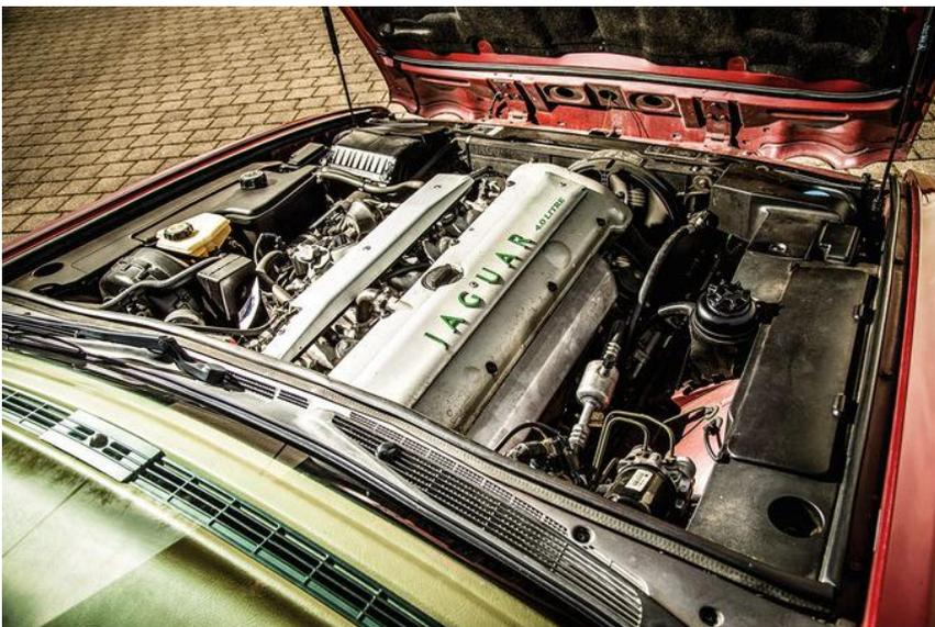
Ein komplett neuer Antrieb erscheint der neuen Firmenleitung hingegen für den Jaguar XJ 6 (X 300) nicht erforderlich. Es bleibt bei den bewährten Doppelnockenwellen-Reihensechszylindern mit 3,2 und 4,0 Litern Hubraum, die allerdings ein paar grundlegende Modifikationen wie optimierte Nockenwellen, neue Kolben und ein verbessertes Motormanagement über sich ergehen lassen müssen.
