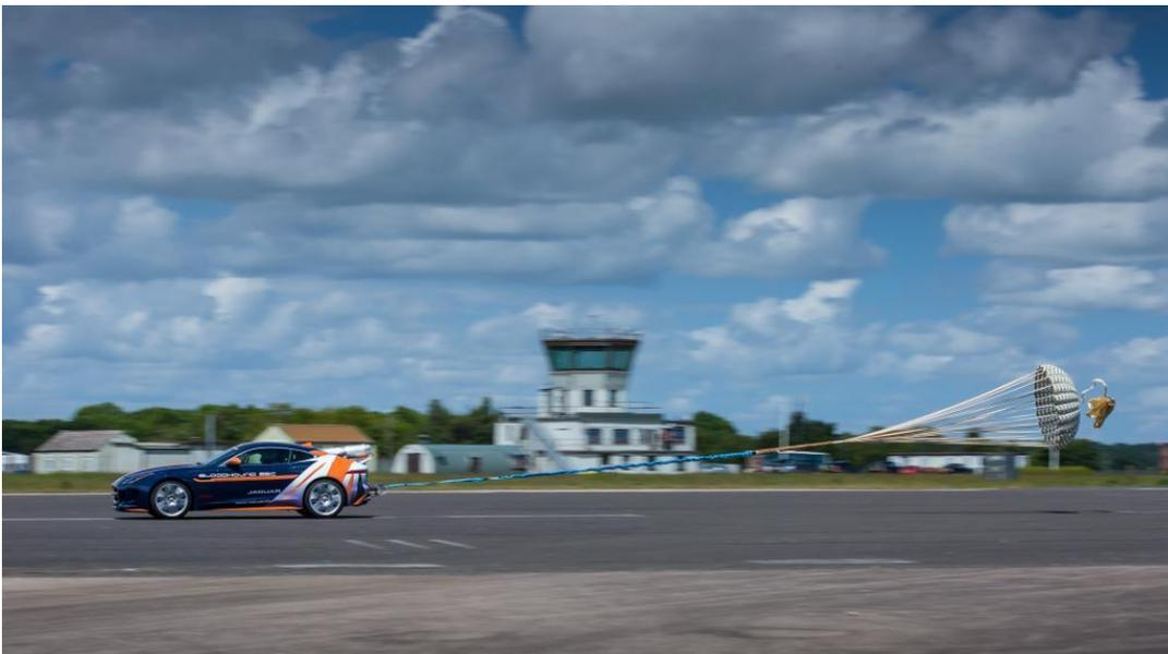
Green löste die Fallschirme durch einen im Cockpit montierten Knopf aus, wodurch sich der Luftwiderstand des F-TYPE schlagartig um eine Tonne erhöhte. Der Jaguar verzögerte wie ein Flugzeug nach der Landung, ehe ihn Green mit Hilfe der Scheibenbremsen zu einem kontrollierten Halt brachte.
