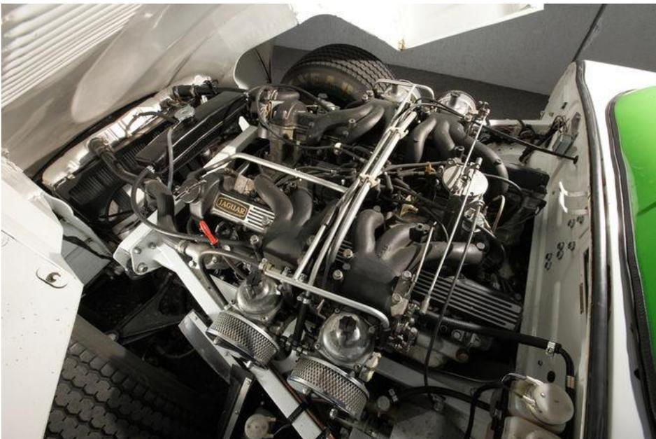
Die Technik entspricht bis auf das modifizierte Fahrwerk und dem Einbau eines amerikanischen Richmond-Sechsganggetriebes komplett der Serien-Version: 5,4 Liter Hubraum und 268 PS.
