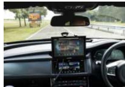
Das Assistenzsystem hilft, diese Art von Auffahrunfällen zu verhindern. Es nutzt die Stereokamera, um den Bereich unmittelbar vor dem Fahrzeug zu überwachen. Erkennt der Assistent Objekte wie Fahrzeuge oder Mauern und erhält gleichzeitig Signale vom Gaspedal oder dem Getriebe, die auf eine bevorstehende Kollision schließen lassen, aktiviert er automatisch die Bremsen und warnt den Fahrer über ein akustisches Signal.
