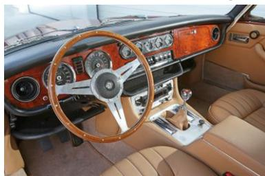
verdient und die in dieser Pracht der ersten XJ-Serie vorbehalten war. Mit sieben runden Smiths-Instrumenten – zwei große für Drehzahl und Vitesse, fünf kleine für Batterie, Öldruck, Wassertemperatur, Uhrzeit und Tank -, dazu eine imposante Kippschalterreihe. Die Freude, in einem besonderen Automobil angekommen zu sein, wird
