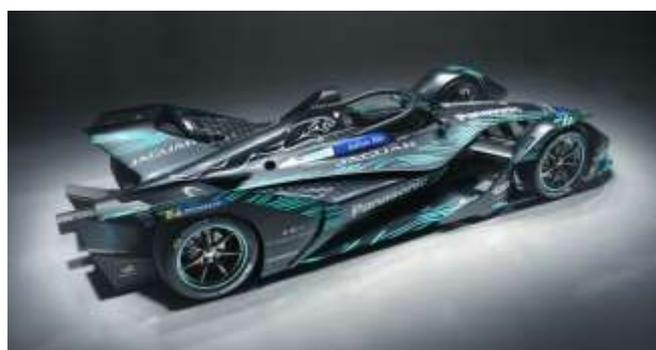
Eine leistungsstärkere Batterie macht in Zukunft den bislang erforderlichen Fahrzeugtausch bei Halbzeit des Rennens überflüssig und demonstriert so die schnelle Weiterentwicklung batterieelektrischer Antriebe. Neu am Jaguar I-TYPE 3 ist auch der ab Saison 5 in der Formel E obligatorische „Halo“-Kopfschutz.
